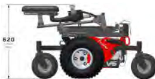
Figura 4.3c Altura plegado Frontier V6 y V4
