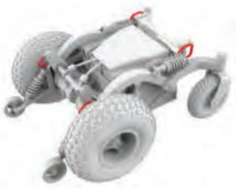
Figura 5.2c Puntos de elevación de Frontier V4
