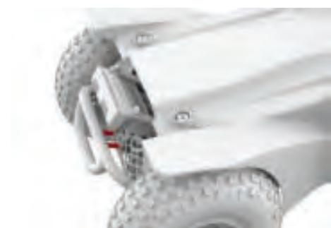
Figura 4.6b Palancas de freno de Extreme X8 liberadas
