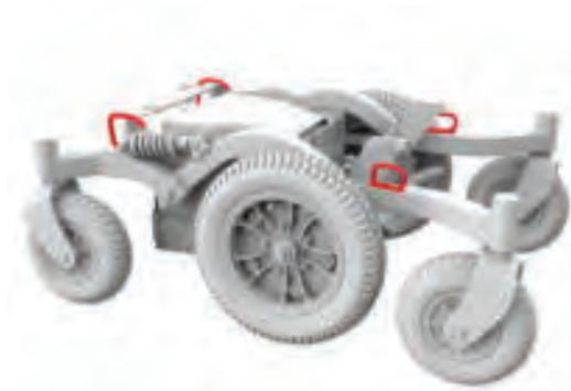
Figura 5.2b Puntos de elevación de Frontier V6
