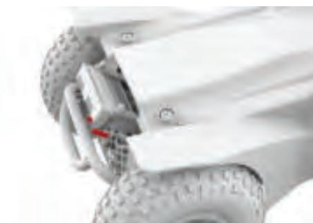
Figura 4.6a Palancas de freno de Extreme X8 activadas
