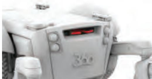
Figura 4.4a Palancas de freno de Magic 360 activadas
