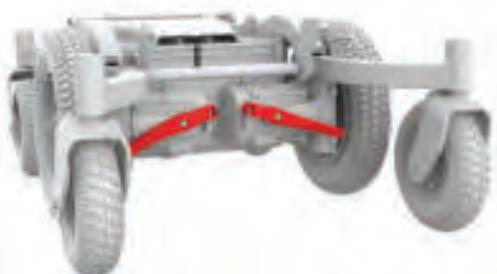
Figura 4.5b Palancas de freno de Frontier V6 liberadas
