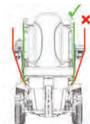
Figura 5.1 Recorrido de las correas de elevación
