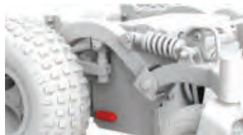
Figura 4.5d Palancas de freno Frontier V4 liberadas
