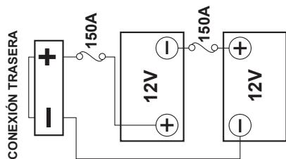
Figura 6.1a - Cableado de la batería de Magic 360
