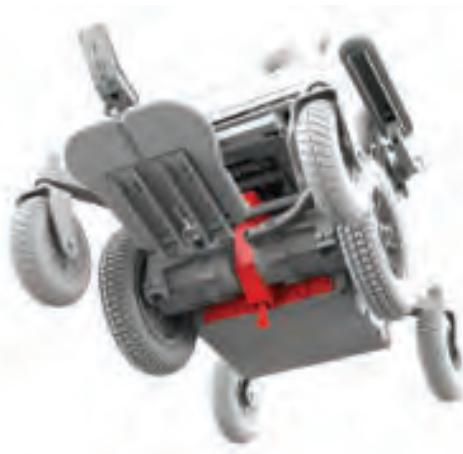
Figura 5.7d Clavija de acoplamiento de Frontier - extendida
