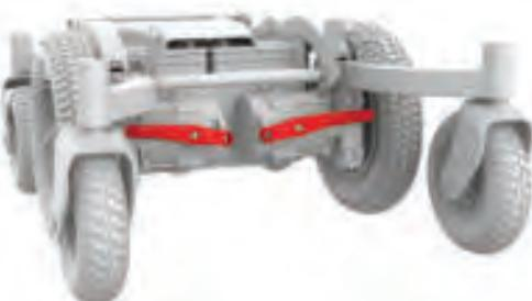
Figura 4.5a Palancas de freno de Frontier V6 activadas
